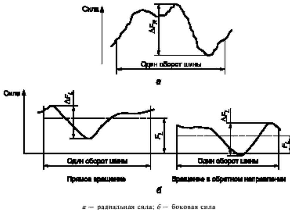
Рисунок 2 — Примеры волнообразных профилей распределения сил, создаваемых шиной
